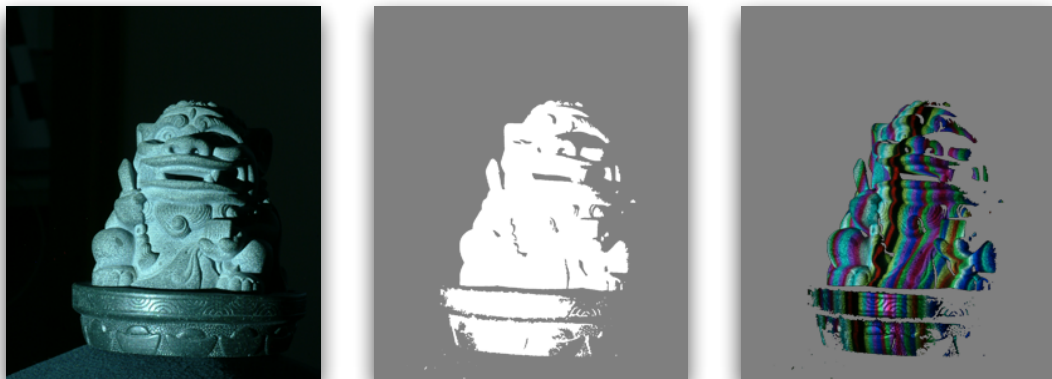
Abbildung 4.1: Vordergrundsegmentierung mit Hilfe einer weiß beleuchteten Aufnahme (links). Wir erhalten den verwendeten Bereich (Mitte), wobei der nicht verwendete Bereich in den weiteren Schritten ausmaskiert wird (rechts).
