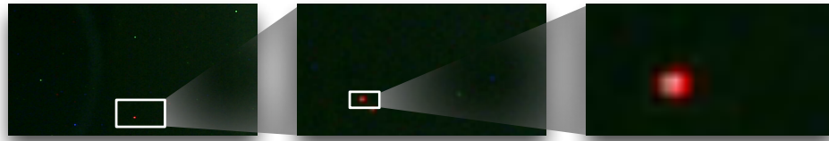
Abbildung 2.19: Von links nach rechts: Eine Vergrößerung einer unkomprimierten Aufnahme im Dunklen mit Blendenzahl F 22, Lichtempfindlichkeit ISO 200 und einer Belichtungszeit von 3 s. Hier wird impulsartiges Rauschen beobachtet, das durch eine erhöhte Belichtungszeit entsteht.
